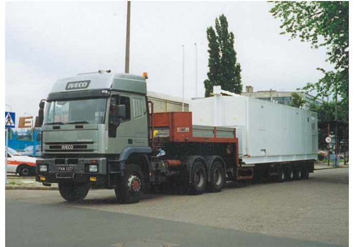
Kontenerowe stacje zasilające są przeznaczone do przewożenia z miejsca na miejsce wg potrzeb inwestora. Cała konstrukcja kontenera wraz z urządzeniami takimi jak transformator, klimatyzator, jest umieszczona na ramie wsporczej. Pozwala to na bezpieczny i bezproblemowy załadunek oraz przewożenie.
